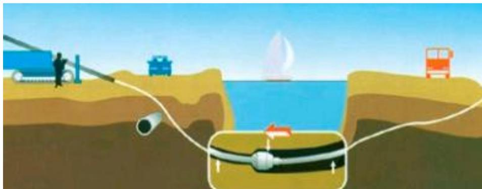
Рисунок 40 Расширение скважины.
