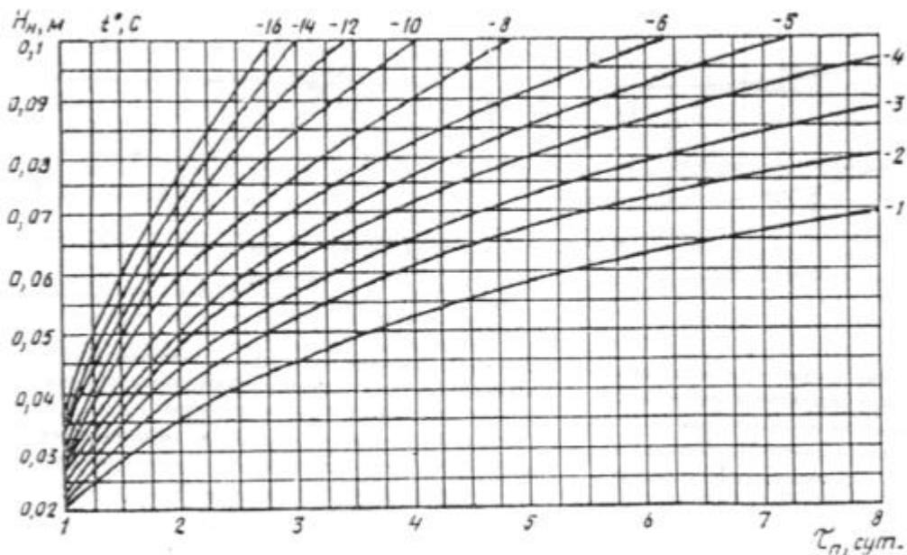
Рис. 7. Зависимость глубины промораживания слоя осадка от среднесуточной температуры воздуха
