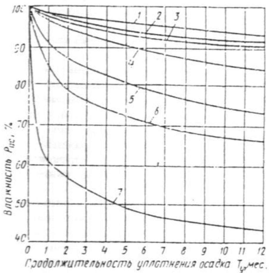
Рис. 3. Средние значения влажности осадка станций осветления и обесцвечивания воды
