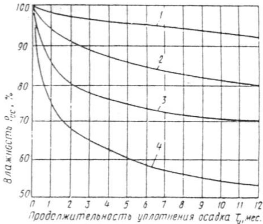
Рис. 4. Средние значения влажности осадка станции обезжелезивания и реагентного
