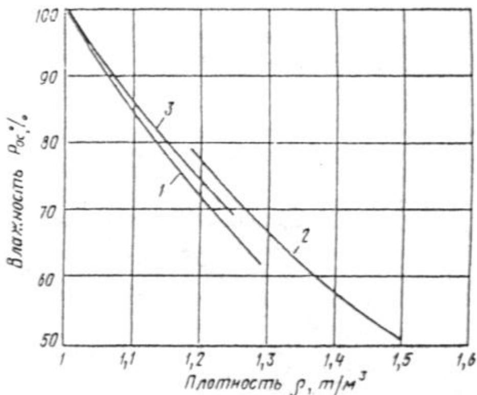
Рис. 6. Значения плотности в зависимости от влажности осадка
