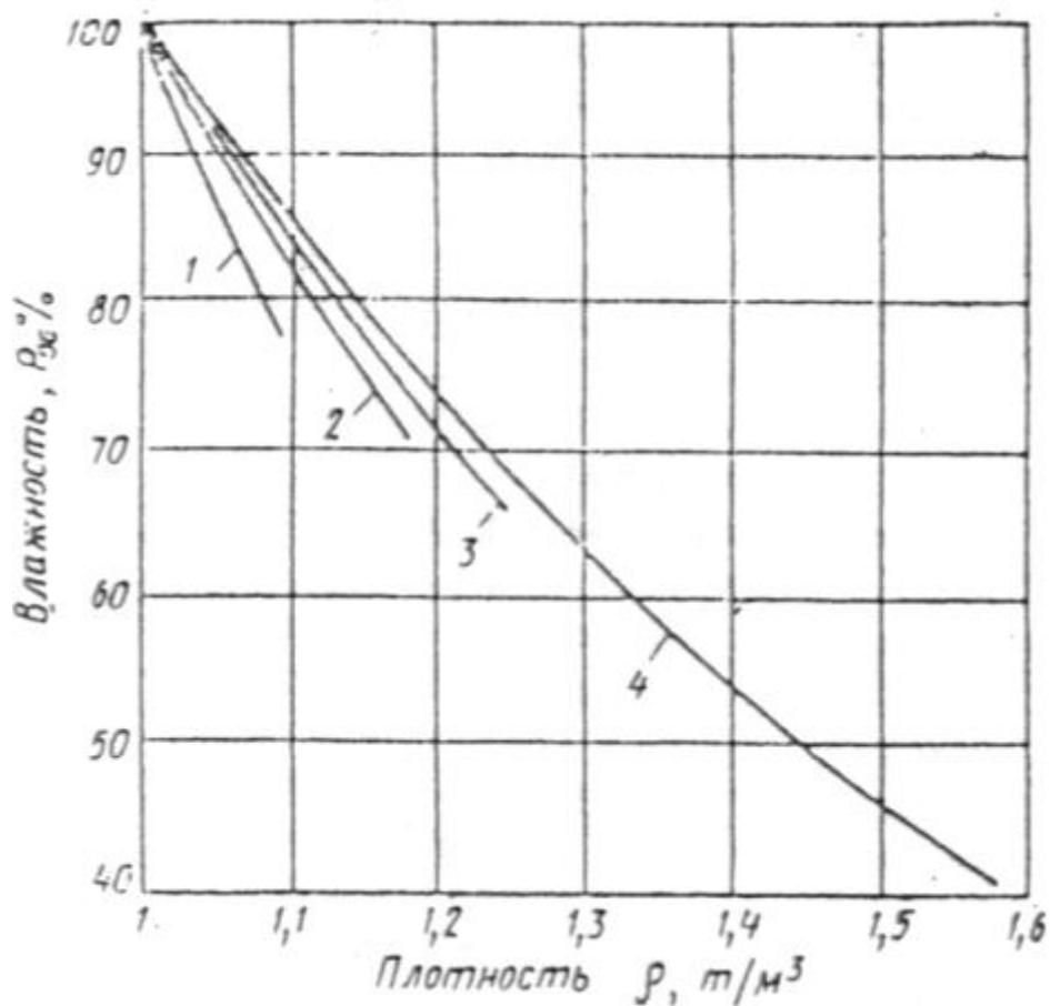
Рис. 5. Значения плотности в зависимости от влажности осадка
