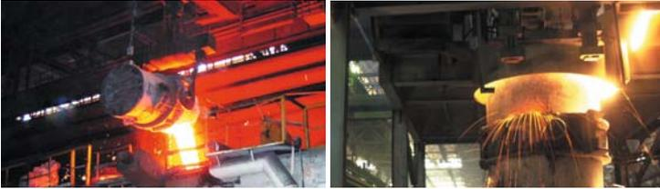
1. Плавильное отделение (десульфурация, доведение до заданного химического состава чугуна, модифицирование)
