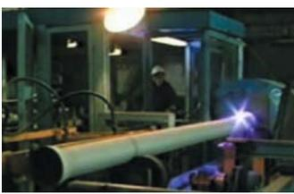
5. Участок нанесения цинкового покрытия
