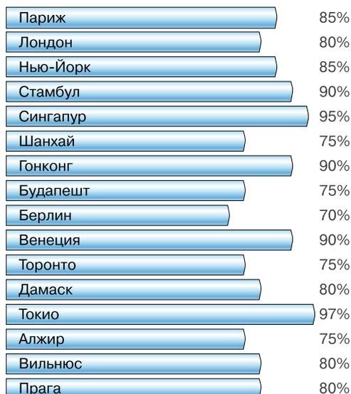
Доли трубопроводных систем из высокопрочного чугуна в системах водоснабжения крупнейших городов мира
